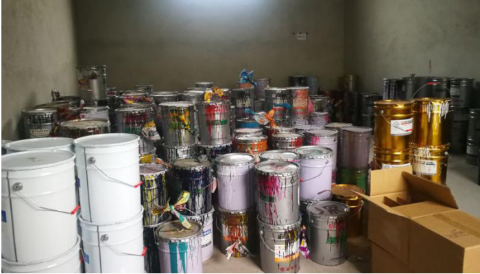
图 4-4 VOCs 物料储存应密闭且在专用场地
