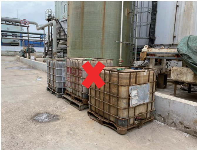
图 2-12 盛装 VOCs 物料的容器未按要求存放
